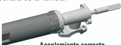
Acoplamiento correcto del quemador con la válvula
